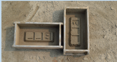
Figure 12 : Gabarits de moule de briques
