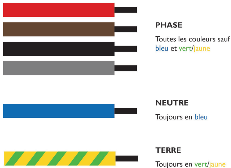
Figure 29 : Différentes couleurs pour différentes utilisations de câbles
