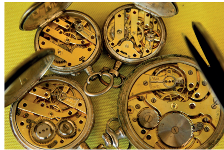
Figure 43 : Mécanisme d'engrenage dans des montres à gousset
