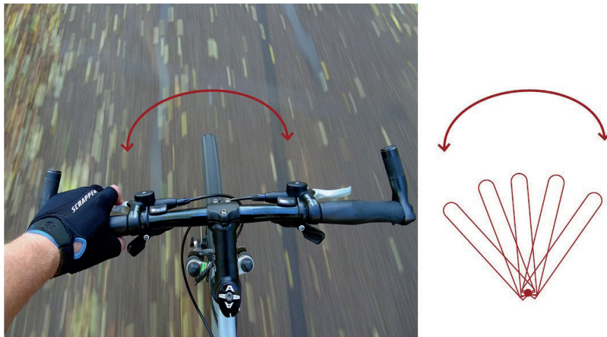
Figure 5 : Guidage en rotation du vélo
