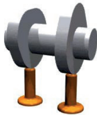
Figure 60 : Arbre à came, système de came et tige poussoir
